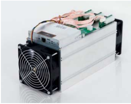
Normale PC-Technik kann beim Bitcoin-Mining nicht mehr mithalten. Professionelle Miner benutzen ASIC-Rechner wie den hier gezeigten „Antminer S9“ von Bitmain.
